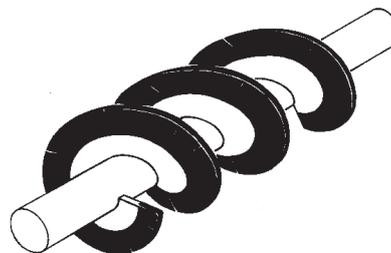
Lors du soudage par rechargement dur sur les matériaux de base à teneur élevée en carbone ou lors du blindage à l'aide de matériau d'apport extrêmement durs avec une dureté de >50 HRC, une couche tampon doit être soudée entre le matériau de base et le blindage. Pour les couches tampons, on peut utiliser les électrodes barres **Fox A7** ou **Fox A7-A** ou les fils massifs **Böhler A7 CN-IG** ou le fil fourré **Böhler A7 PW-FD** et à l'extérieur, notamment le fil fourré Open-Arc **SK 402-O**.
