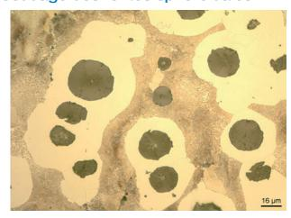
Le risque de fissuration par rapport à la fonte lamellaire est réduit. Cette particularité découle de la haute ténacité (allongement selon la classe de résistance 2-22%).
