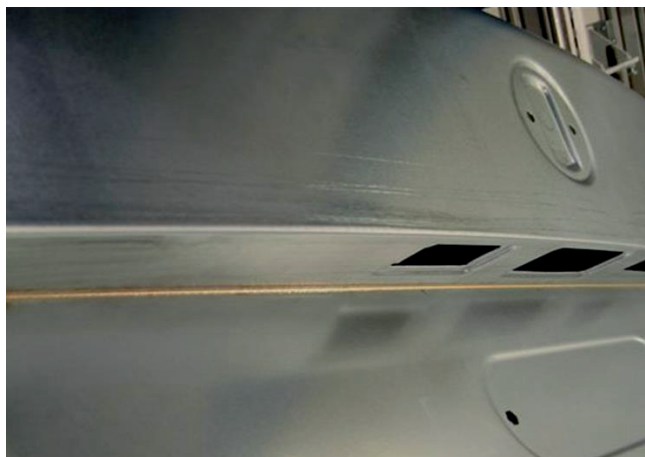
Capot du coffre d'une voiture soudé au laser avec Fontargen A 202 M
