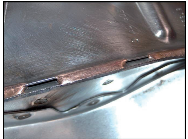
Brasage MSG P dans l'industrie automobile avec Fontargen A 202 M
