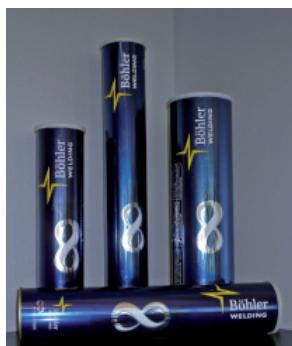
Le conditionnement en boîtes est un emballage hermétique qui garantit le stockage des électrodes dans un emballage non endommagé pendant une longue période, même dans les conditions les plus défavorables. Après l'ouverture de la boîte, les électrodes sont soudables sans étuvage.
